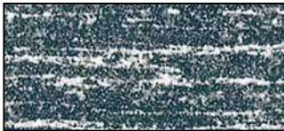
Herkömmlicher HSS-Fräser • spröde Kornstruktur • begrenzte Festigkeit
